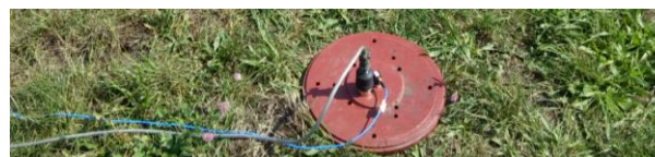
Rys. 5. Sposób mocowania czujników drgań.
