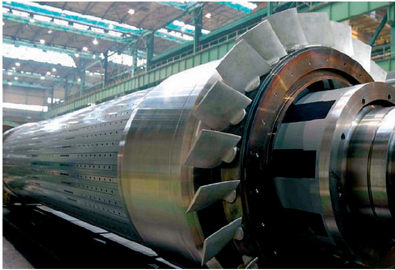
Fot. 1. Nowe wentylatory wirnika turbogeneratora
