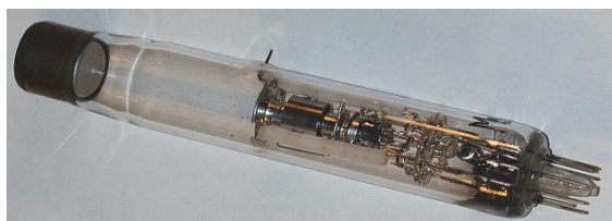
Fot. 9. Lampa rentgenowska z anodą transmisyjną [9]
