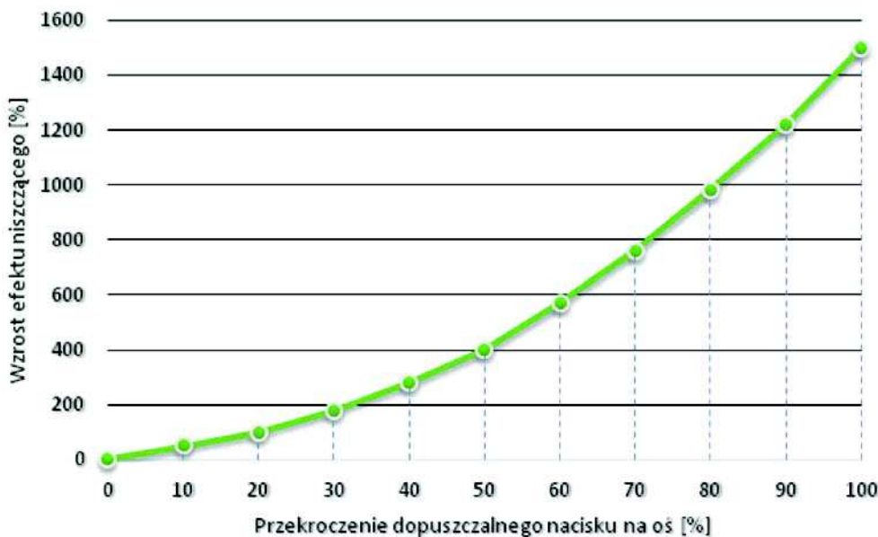
Rys. 4. Wzrost efektu niszczącego pojazdu przeciążonego. Źródło: [5]
