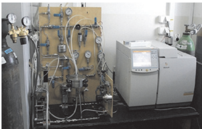
Rys. 4. Stanowisko laboratoryjne IChP do badań procesu separacji gazów (GC online) Fig. 4. The ICRI laboratory test rig for membrane gas separation (GC online)
