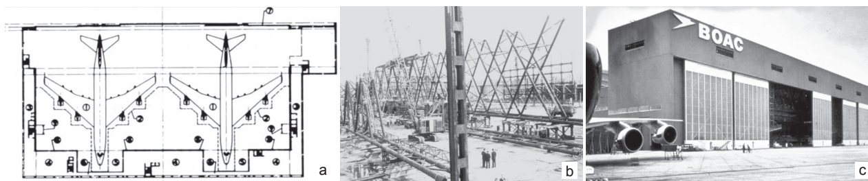
Il. 8. Hangar 01 do konserwacji samolotów Boeing 747 na lotnisku Heathrow w Londynie: a) schematyczny widok hangaru z góry, b) dźwigar grzbietowy i fryzowy w trakcie konstrukcji, c) wejście do hangaru (źródło: Space Structures Research Centre Archives, University of Surrey)
