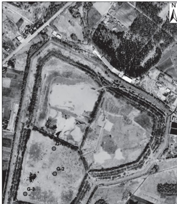
Fig. 3. The location of boreholes and sampling spots in the “Gardawice” landfill Rys. 3 Lokalizacja odwiertów i punktów poboru próbek na składowisku „Gardawice”
