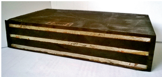
Fot. 5. Przekrój bloku łożyska elastomerowego zbrojonego trzema blachami (ze zbioru autora)
