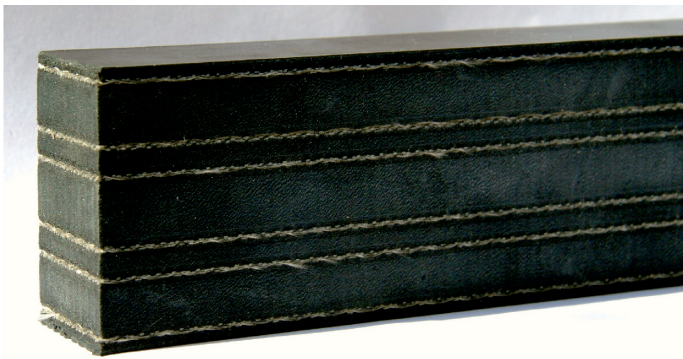
Fot. 1. Fragment łożyska elastomerowego zbrojonego włóknami bawełniano-poliestrowymi (ze zbioru autora)
