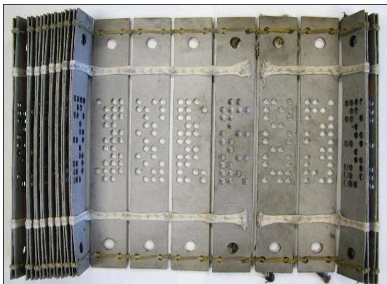
Rysunek 1. Perforowane metalowe płytki używane w warsztatach tkackich Jacquarta.
