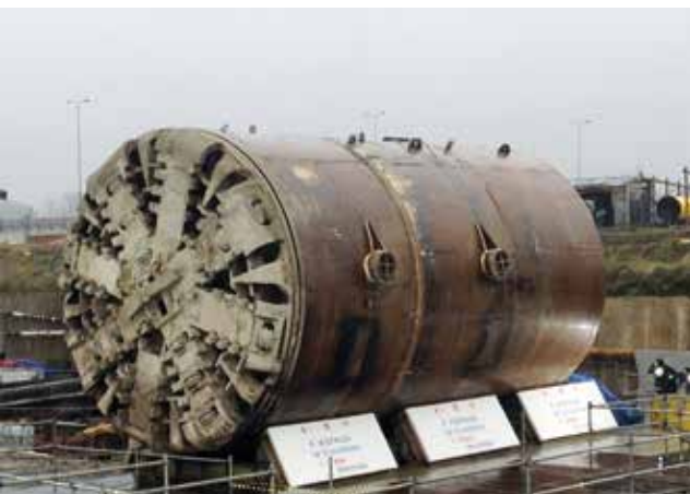
Rys. 6. Widok tarczy zmechanizowanej, która wydrążyła odcinek praski II linii oraz tunele metra pod Wisłą (fot. autor)
