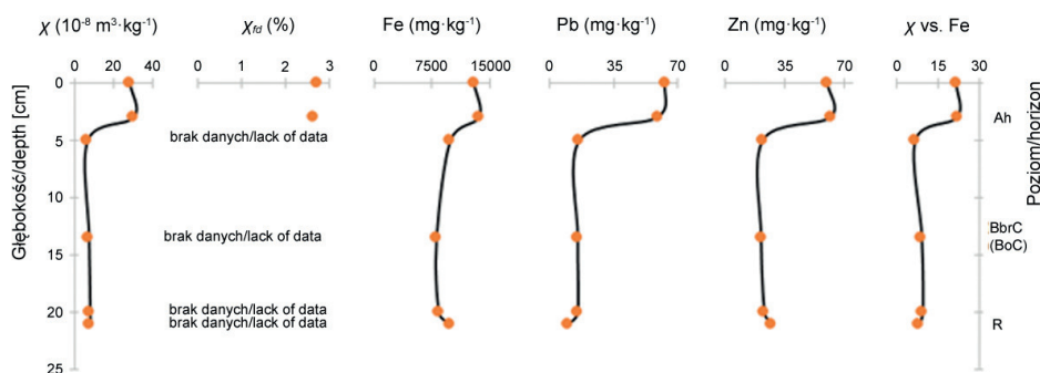
Rys. 4. Rozkład pionowy masy podatności magnetycznej ( \chi ), zależności częstotliwościowej podatności magnetycznej ( \chi_{fd} ), zawartości żelaza (Fe), zawartości ołowiu (Pb), zawartości cynku (Zn), stosunku \chi/\text{Fe} ( 10^{-12} \text{ m}^3 \cdot \text{kg}^{-1} / \text{mg} \cdot \text{kg}^{-1} \text{ Fe} ) w rankerze brunatnym wytworzonym z granitoidu żułowskiego (profil nr 1)
