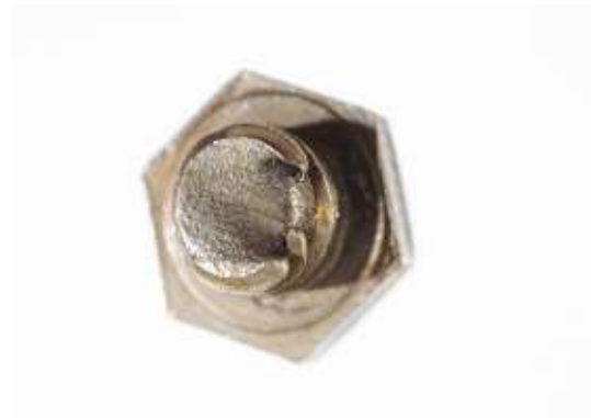
Rys. 8. Przelom ciągliwy [1]. Fig. 8. Tough breakthrough [1].
