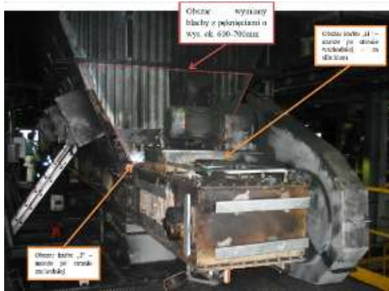
Rys. 6. Lokalizacja obszarów karbu „I” i „II” [1]. Fig. 6. Location of the notch areas "I" and "II" [1].
