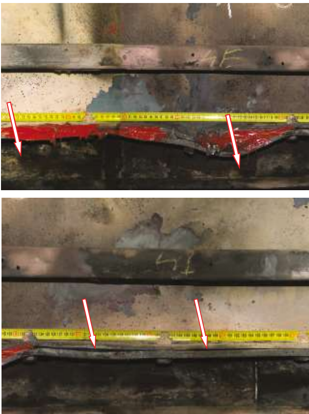
Rys. 3. Rozległe deformacje z dużą ilością masy uszczelniającej i jednocześnie z brakiem szczelności dla niektórych obszarów konstrukcji filtru [1].
