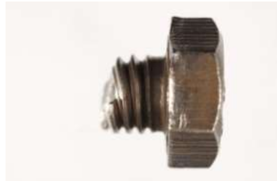
Rys. 7. Znaczące trwałe deformacje na powierzchni zwojów gwintu śruby [1].
