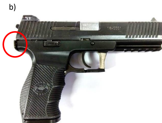
Fot. 3. Model pistoletu PW INKA ze szkieletem wykonanym techniką druku 3D:
