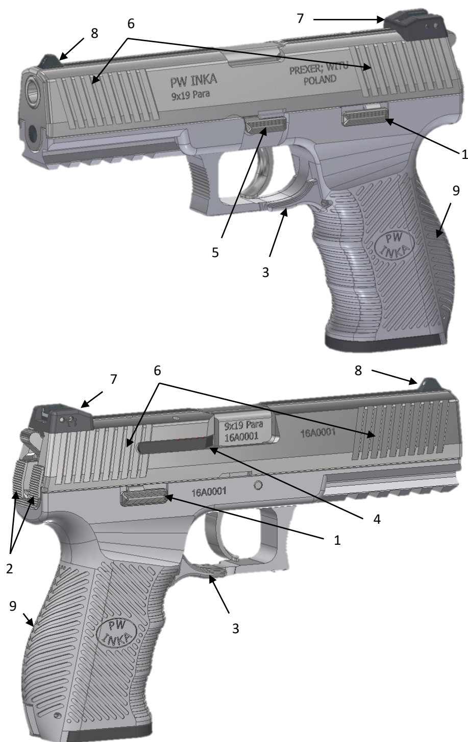
Rys. 1. Pistolet PW INKA (widok z lewej i prawej strony): 1-zaczep zamka, 2-zwalniacz kurka; 3-zatrzask magazynka, 4-wyciąg ze wskaźnikiem obecności naboju w komorze naboju, 5-dźwignia rozkładania, 6-rowki antypoślizgowe, 7-regulowana szczerbinka, 8-wymienna muszka, 9-wymienna nakładka chwytu w trzech rozmiarach [2]
