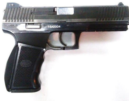
Fot. 2. Model pistoletu PW INKA ze szkieletem wykonanym obróbką ubytkową z aluminium [1]
