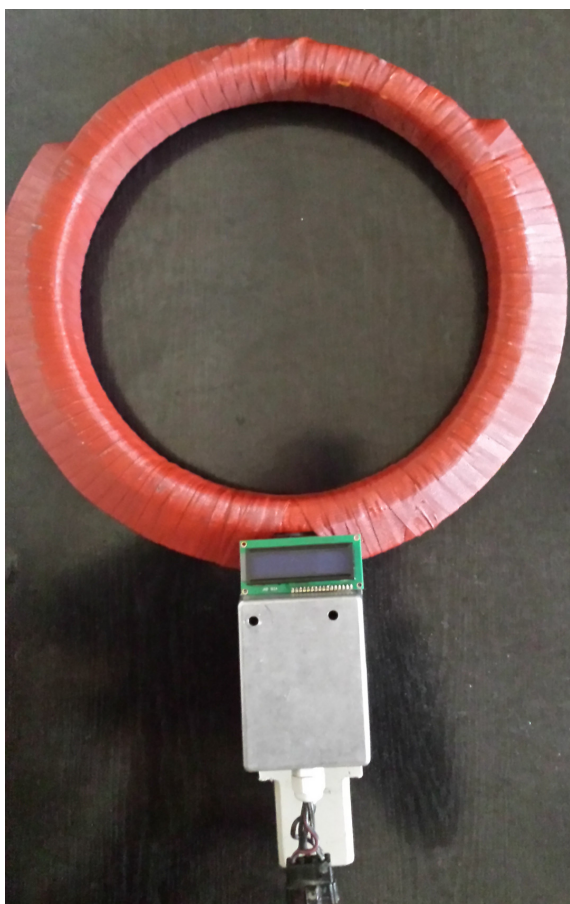
Rys. 2. Prototyp przyrządu do oceny stanu klatki wirnika
