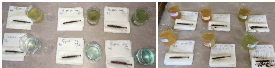
Fig. 2. Samples with the amount of copper deposited on the iron, from different days of the experiment Rys. 2. Próbkę z ilością miedzi osadzonej na żelazie, z różnych dni eksperymentu
