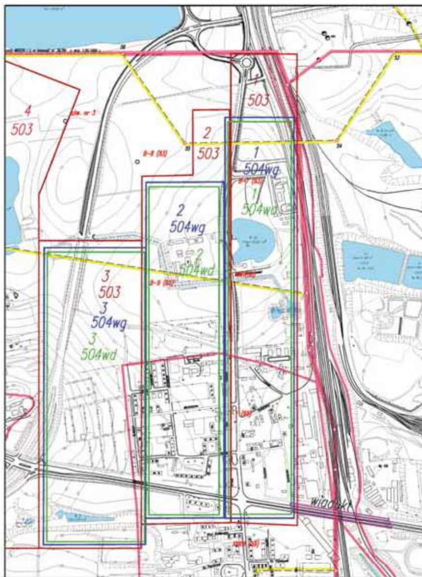
Rys. 1. Położenie krawędzi parcel eksploatacji dokonanej od 1994 r. (ściany 1, 2, 3 i 4 w pokładzie 503 oraz ściany 1, 2 i 3 w pokładzie 504 wg) i projektowanej (ściany 1, 2 i 3 w pokładzie 504 wd) w stosunku do wiaduktu drogowego nad torami PKP w ciągu ul. Wrocławskiej
