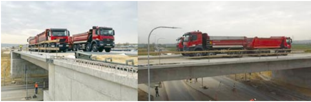
Rys. 6. Próbné obciążenie ustroju nośnego WG-4
