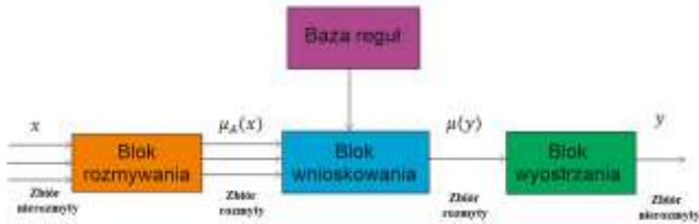
Rys. 5. Schemat działania układu rozmytego
