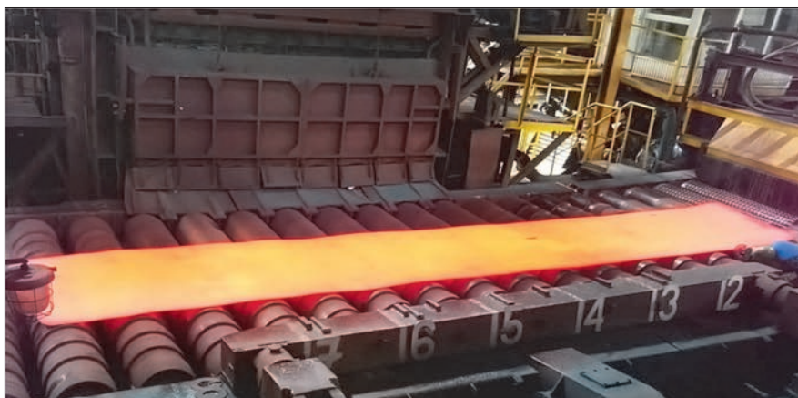
Rys. 5. Walcowanie na gorąco blachy ze stali nanobainitycznej
