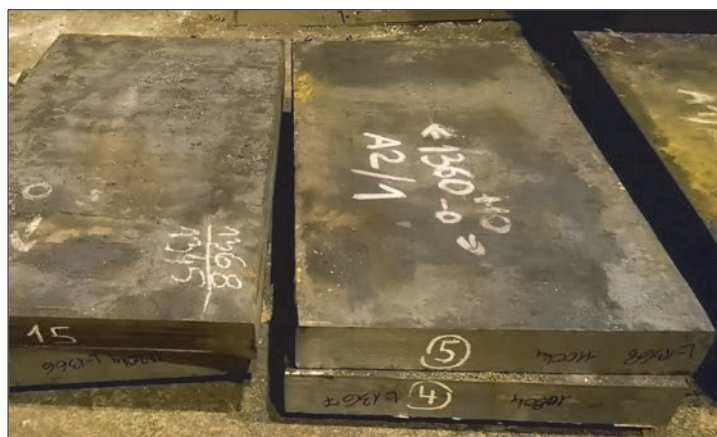
Rys. 4. Slaby kute z wytopu 882917 – stal NBA-P1 przygotowane w formie odcinków wsadowych do walcowania na gorąco blach Fig. 4. Slabs forged from heat 882917 – NBA-P1 steel prepared in the form of charge sections for hot rolling of plates
