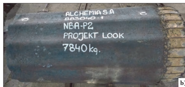
Rys. 3. Fotografie wlewków formatu Q8 z wytopu nr 882917 – gatunek stali NBA-P1 (a) oraz z wytopu nr 883040 – gatunek stali NBA-P2 (b) Fig. 3. Photographs of Q8 ingots from heat No. 882917 – steel grade NBA-P1 (a) and from heat No. 883040 – steel grade NBA-P2 (b)
