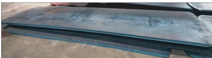
Rys. 6. Spowolnione stygnięcie w stosie po walcowaniu blach ze stali nanobainitycznej
