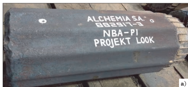
Rys. 3. Fotografie wlewków formatu Q8 z wytopu nr 882917 – gatunek stali NBA-P1 (a) oraz z wytopu nr 883040 – gatunek stali NBA-P2 (b) Fig. 3. Photographs of Q8 ingots from heat No. 882917 – steel grade NBA-P1 (a) and from heat No. 883040 – steel grade NBA-P2 (b)
