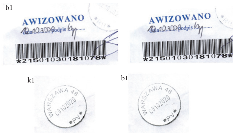
Rys. 2. Skany pieczętki i nadruku na kopercie: b1 — po procesie likwidacji skażeń (800 dpi); k1 — próbka kontrolna (300 dpi)
