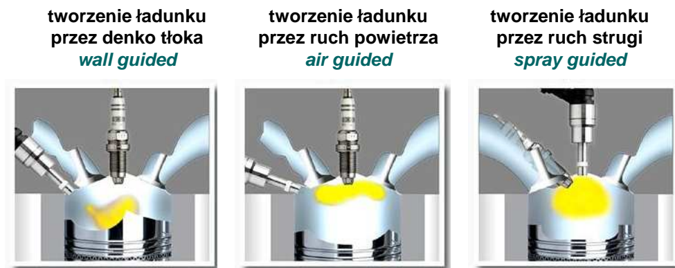
Rys. 1. Dotychczasowe rozwiązania układów bezpośredniego wtrysku benzyny Źródło: [4]
