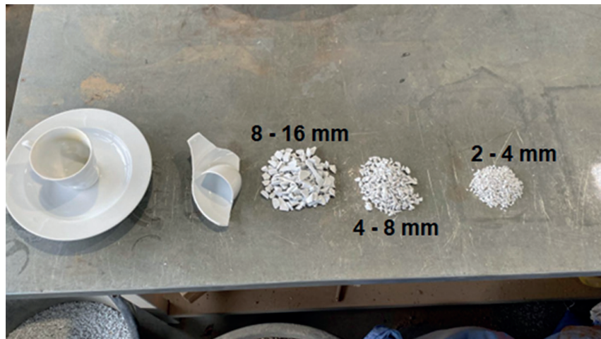
Rys. 2. Zastosowane jako kruszywo odpady ceramiczne przed i po procesie kruszenia oraz przesiewania
