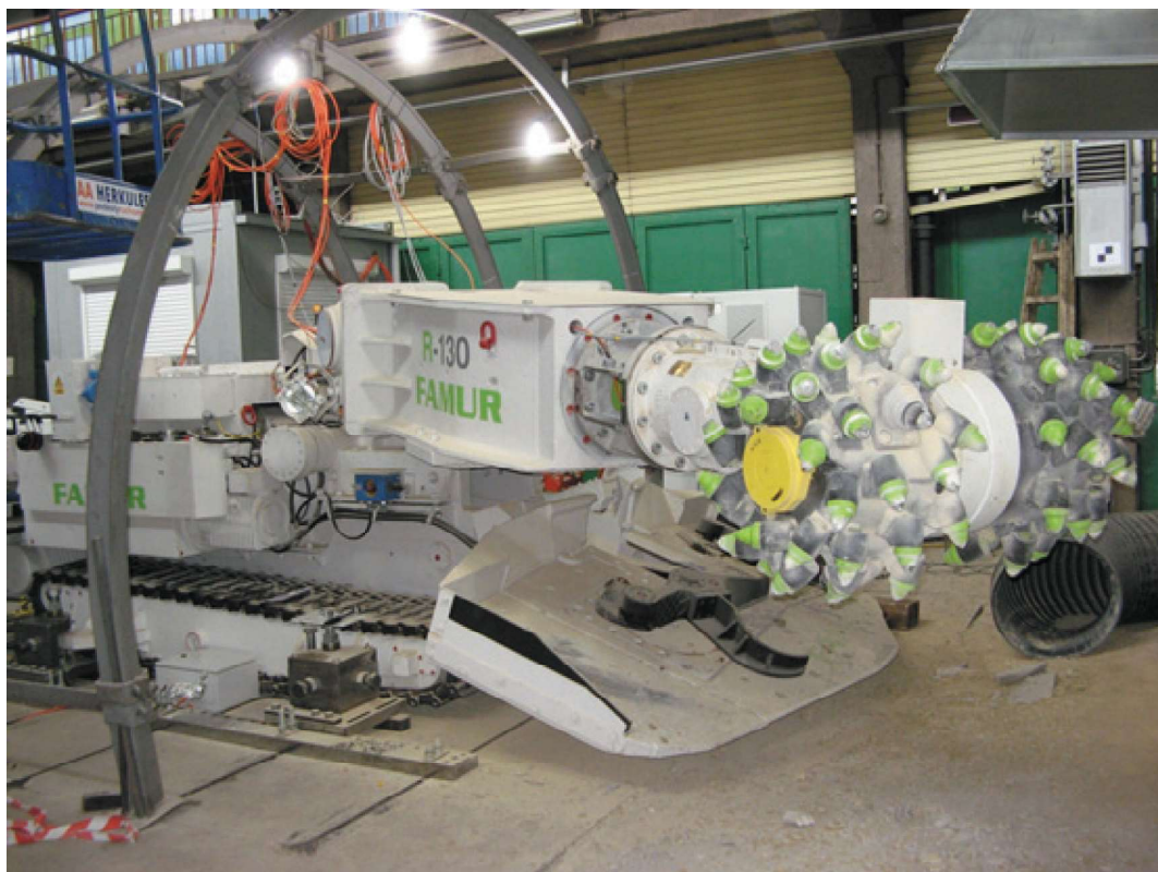
Rys. 1. Obiekt badań: kombajn chodnikowy R-130 na stanowisku badawczym wraz z torami pomiarowymi Fig. 1. The research subject : R-130 roadheader on a test station with measuring system
