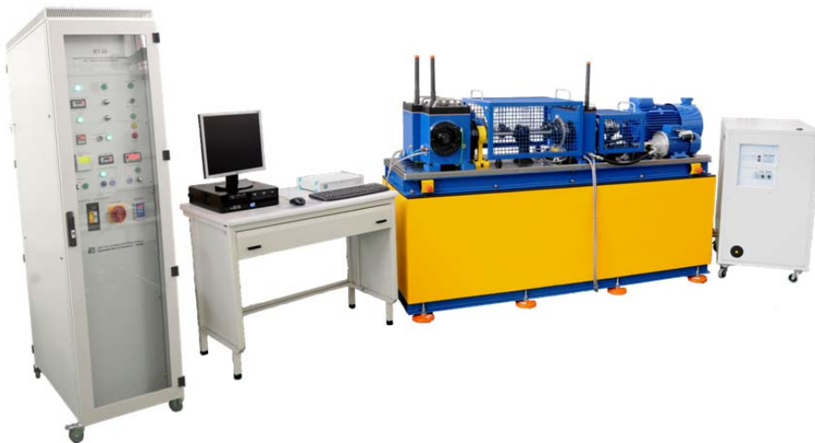
Rys. 2. Urządzenie T-30 do badania kół zębatych stożkowych
