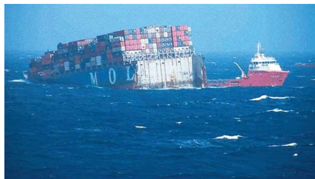
Rys. 5. Część dziobowa kontenerowca m/v MOL Comfort holowana przez jednostkę ratowniczą [4]
