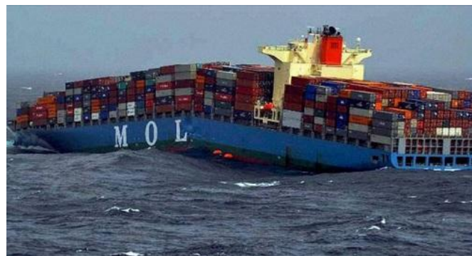
Rys. 4. Kontenerowiec m/v MOL Comfort zламаł się na skutek zmęczenia materiału dna podwójnego [4]
