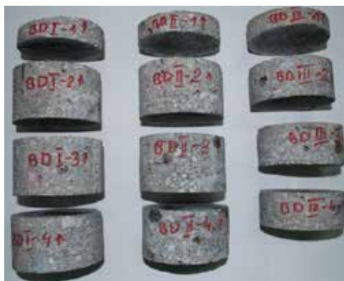
Rys. 3. Odwierty rdzeniowe przygotowane do badań nasiąkliwości
