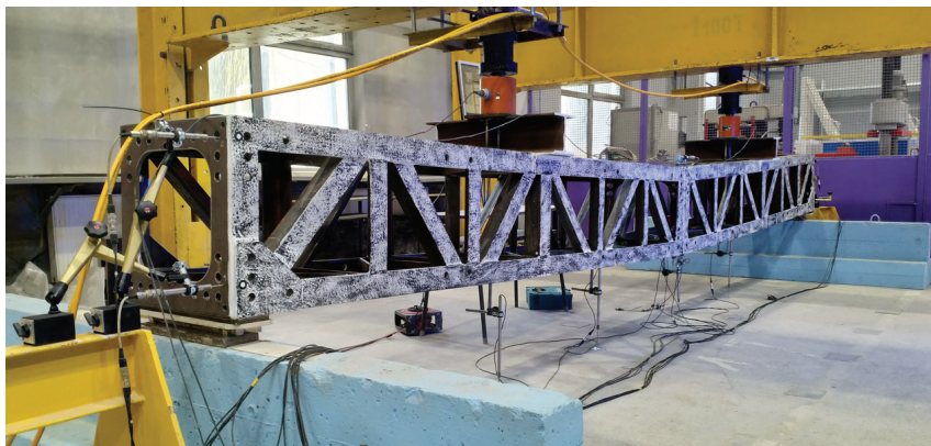
Fot. 3. Badanie laboratoryjne sekcji liniowej konstrukcji słupów EN412:16
