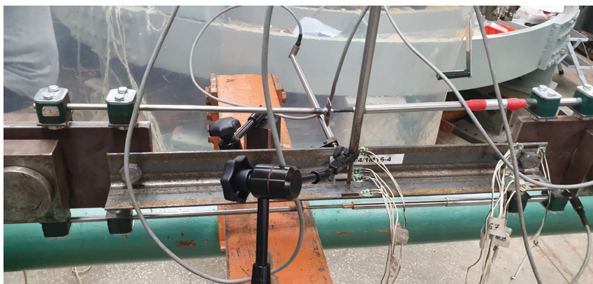
Fot. 5. Badanie połączenia śrubowego rozciąganego kątownika łączonego jednym ramieniem
