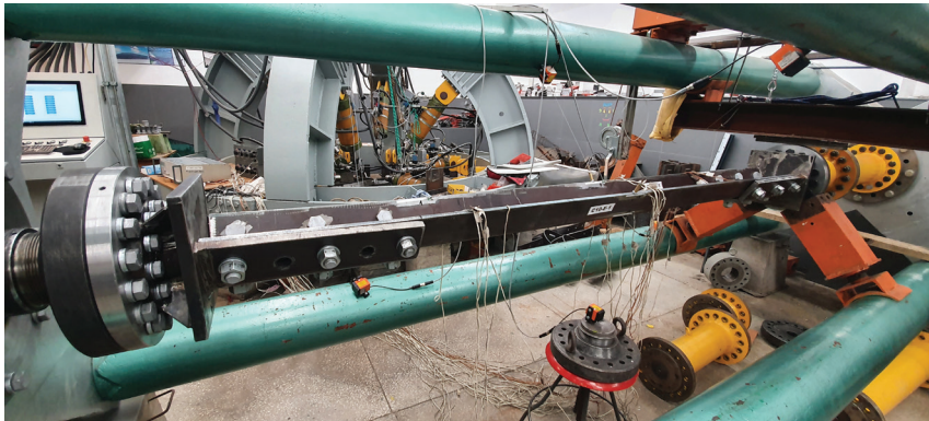
Fot. 6. Badanie ściskane go ceownika z odgiętymi pasami profilowanego na zimno
