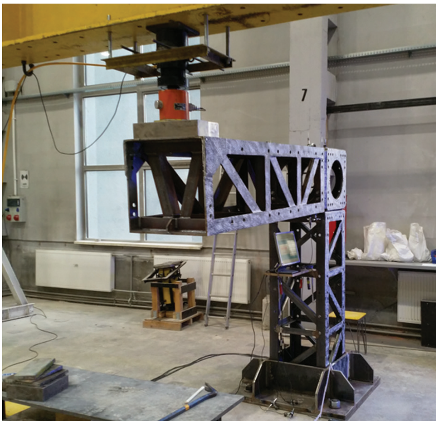
Fot. 4. Badanie laboratoryjne sekcji kątowej konstrukcji słupów EN412:16
