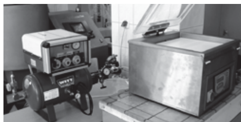
Rys. 2. Stanowisko badawcze: a) od lewej mieszalnik gazów KM100Mem ze zbiornikiem, butle i armatura gazowa, pakowaczka próżniowa PP 5.4, b) analizator gazu typu OXYBABY firmy WITT.
