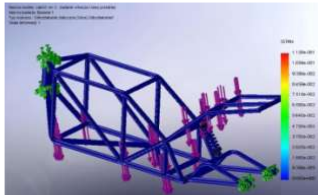
Rys. 12. Wartości odkształceń równoważnych dla zespołu konstrukcji ramy
