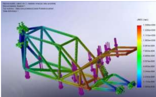
Rys. 11. Rozkład przemieszczeń dla zespołu konstrukcji ramy
