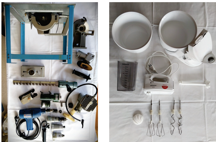
Rys. 1. Przykłady obiektów o konstrukcji segmentowej: elektronarzędzia EMA Combi / Celma (po lewej), urządzenia gospodarstwa domowego Zelmotor (po prawej)
