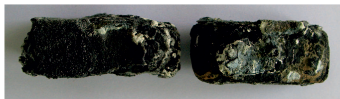
Rys. 1. Wygląd próbki stwardniałego zaczynu cementowego nieodpornego na H 2 S, deponowanego w wodzie złożowej nasyconej siarkowodorem (wytrzymałość na ściskanie około 1,5–2 MPa)
