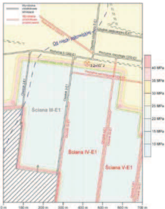
Rys. 3. Rozkład naprężeń na horyzoncie pokładu 706 i 706 + 707/ 1-2 , pole ściany III-E1
