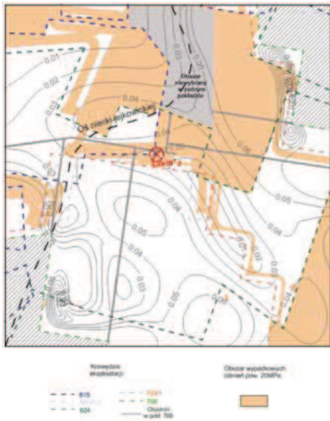
Rys. 7 Izolinie krzywizn deformacji piaskowca zalegającego w odległości około 14 m nad pokładem 706 i 706+707/1-2 na tle obszarów ciśnień wypadkowych oddziaływania krawędzi nadległych pokładów 615 i 625
