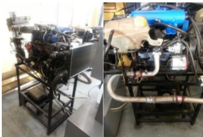
Rys. 1. Stanowisko badawcze wyposażone w silnik z zapłonem iskrowym (fot. S. Kilimnik) Fig. 1. Research lab with spark-ignition engine (photo by S. Kilimnik)
