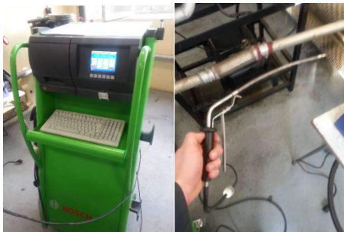
Rys. 2. Analizator spalin Bosch BEA 250 (fot. S. Kilimnik) Fig. 2. Exhaust gas analyzer Bosch BEA 250 (photo by S. Kilimnik)
