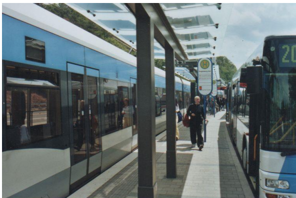
Rys. 3. Tramwaj dwusystemowy na sieci „Saarbahn” przy peronie przystanku Riegelsberg Süd, który umożliwia przesiadkę pasażerom na autobus w systemie „drzwi w drzwi” [23].
