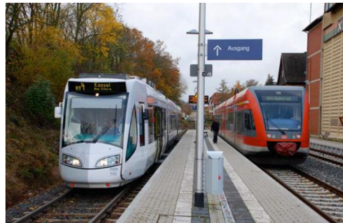
Rys. 8. Tramwaj dwusystemowy hybrydowy (o napędzie spalinowo-elektrycznym) serii RegioCitadis zatrzymujący się przy peronie przystankowym na nieelektryfikowanej linii RT 4 do Wolfhagen w rejonie Kassel [15]
