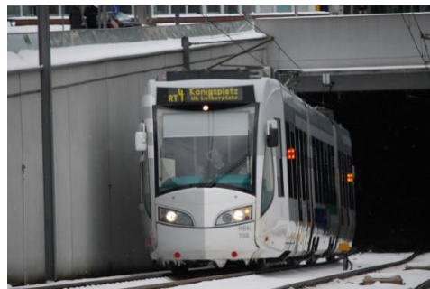
Rys. 9. Tramwaj dwusystemowy RegioTram korzystający ze stromej rampy położonej w tunelu prowadzącym do jednego z trzech peronów Dworca Głównego Kassel Hbf przeznaczonych dla pojazdów RegioTram [7]
