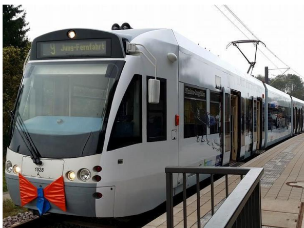
Rys. 2. Tramwaj dwusystemowy FLEXITY Link firmy Bombardier podczas uroczystości otwarcia przedłużenia sieci „Saarbahn” do Lebach [13]
