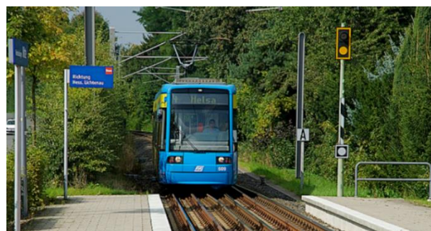
Rys. 5. Tramwaj o klasycznych wymiarach szerokości pudła zbliżający się do peronu przystankowego na jednotorowej linii Kassel Hbf - Hessisch Lichtenau w Kassel [8]
