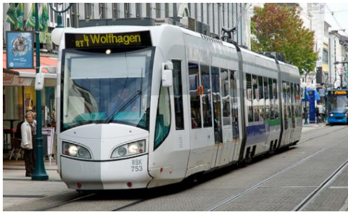
Rys. 6. Dwusystemowy tramwaj RegioCitadis firmy Alstom poruszający się po torowiskach tramwajowych na ulicach Kassel [8]
