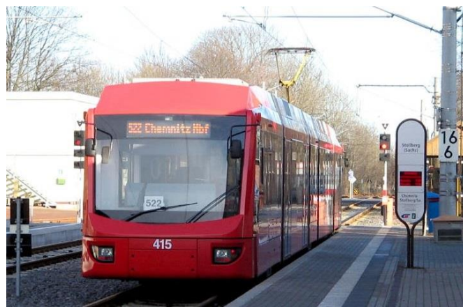
Rys. 16. Tramwaj dwusystemowy Variobahn stojący na stacji w Stollberg [1]
