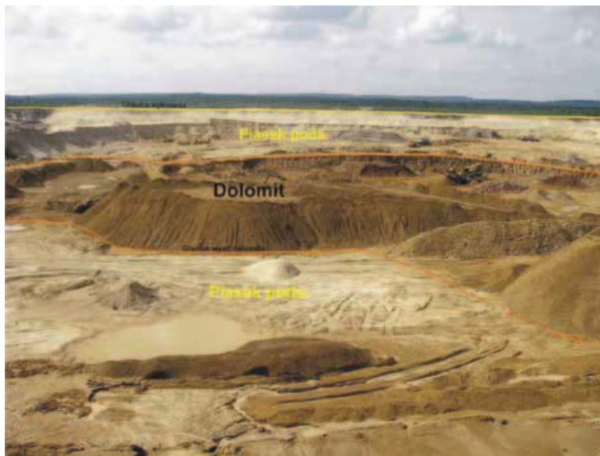
Rys. 3. Pole „Bolesław” – eksploatacja kopaliny głównej (piasku podsadzkiego i budowlanego – poniżej zdjęcia i na dalszym planie) oraz kopaliny towarzyszącej (dolomitu – w centralnej części zdjęcia) (fot.: S. Bednarczyk)
