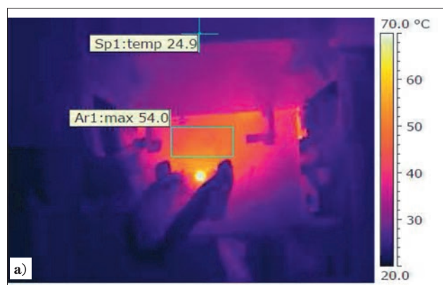
Rys. 6. Fragment pieca szybowego w trakcie a) uruchamiania, b) pracy
