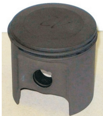
Fig. 11. Carbon piston of Hirth S1200 HF and 3503 HF engines [10] Rys. 11. Grafitowy tłok silników Hirth S1200 HF oraz 3503 HF [10]
