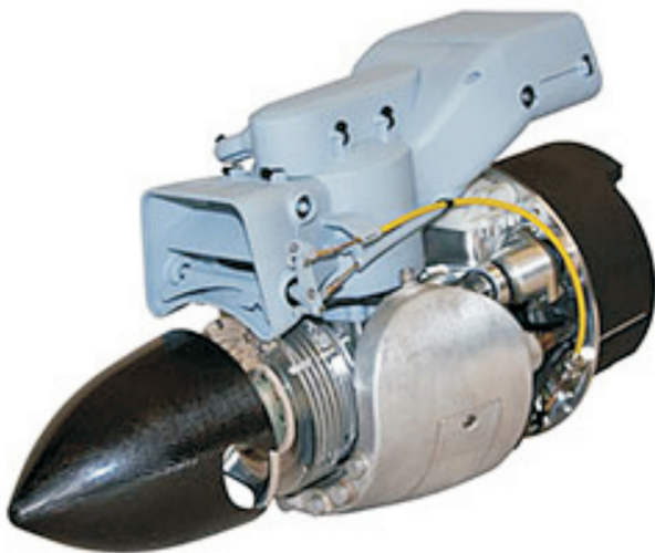
Fig. 23. NW-44 EFI HFE engine; configuration with special silencer[25] Rys. 23. Silnik NW-44 EFI HFE; wersja ze specjalnym tłumikiem wydechu [25]
