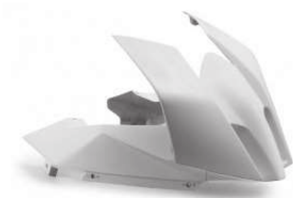
Rys. 10. Owiewka motocyklowa wykonana z włókna szklanego [11]
