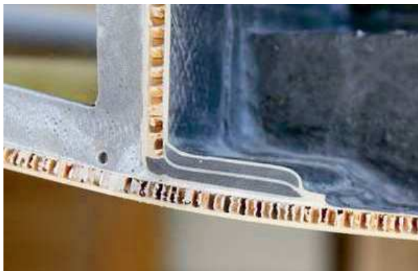
Rys. 16. Wzmocnienie wykonane przy zastosowaniu włókna węglowego [24]
