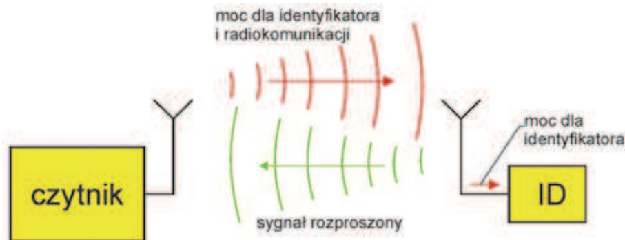
Rys. 1. Schemat blokowy systemu RFID z identyfikatorem pasywnym. ID – identyfikator
