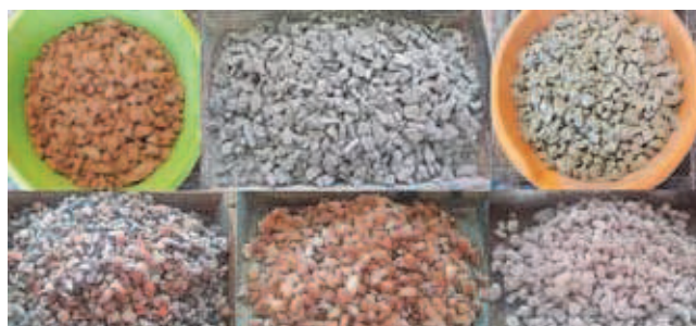
Rys. 5. Próbkki kruszyw przed pokruszeniem: melafir, bazalt, granit, gruz budowlany, cegła, gazobeton
