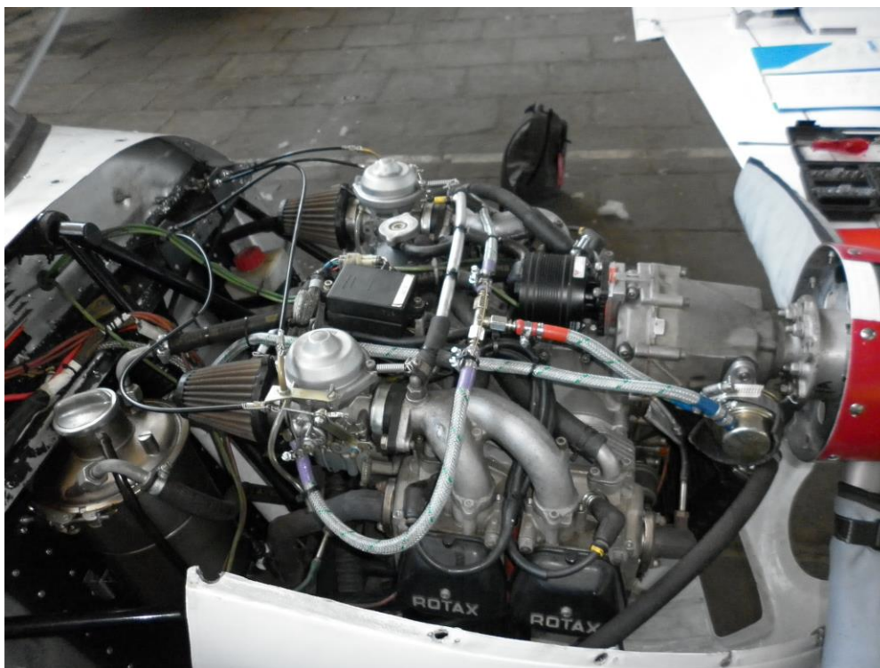
Rys. 2. Niecertyfikowany silnik Rotax popularnie stosowany w samolotach ultralekkich (fot. R. Konieczka)
