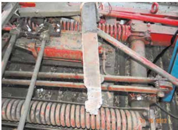
Fot. 8. Uszkodzenia węglowych nakładek stykowych spowodowane odspojeniem się nakładek stykowych
