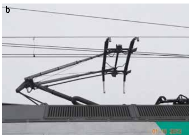
Fot. 2. Pantograf: a) typu EC-160 ze ślizgaczem pojedynczym i otwartym nabeżnikiem; b) typu WBL-85 DC ze ślizgaczem podwójnym (bliźniaczym) i otwartym nabeżnikiem
