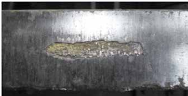
Fot. 4. Wyluszczenie materiału nakładki stykowej wynikające z wewnętrznej wady materiałowej
