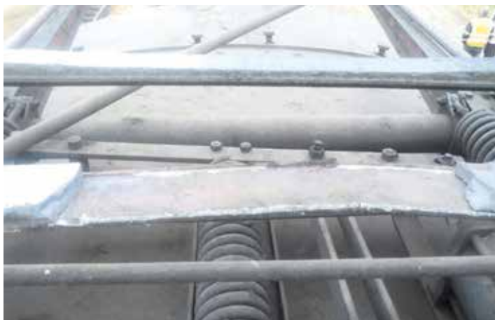
Fot. 8. Uszkodzenia węglowych nakładek stykowych spowodowane odspojeniem się nakładek stykowych
