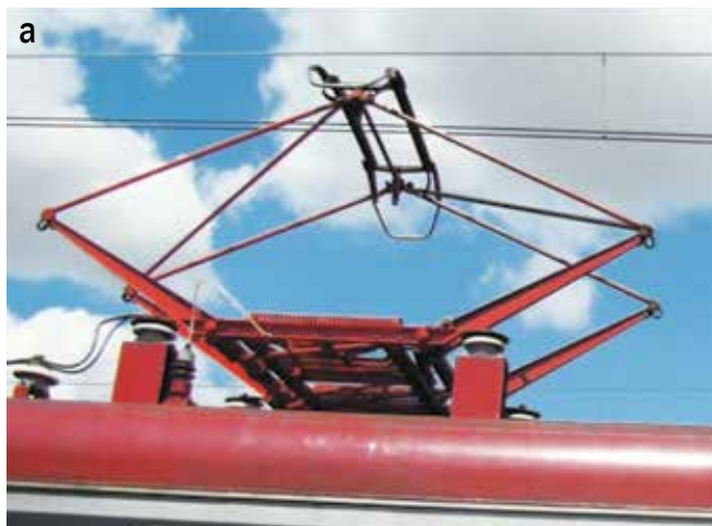
Fot. 1. Odbierak prądu wyposażony w nowe nakładki węglowe a) typu 5-ZL, b) typu AKP-4E
