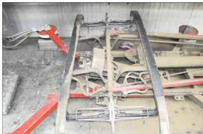
Fot. 6. Niewłaściwie zamontowane nakładki stykowe w ślizgaczu bliźniaczym
