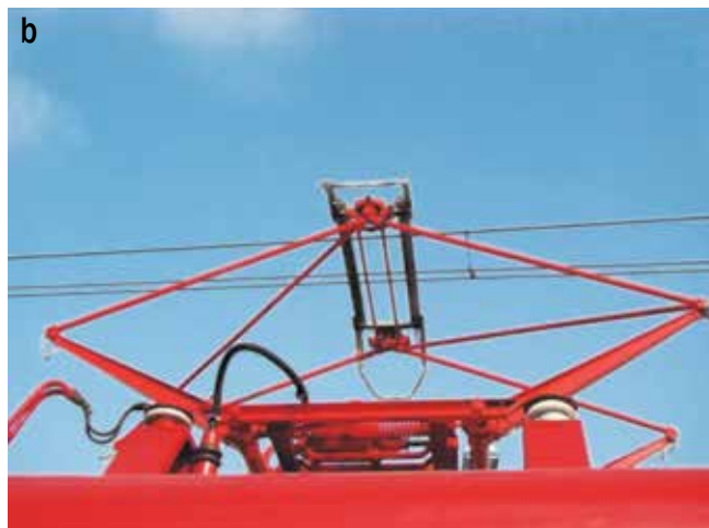
Fot. 1. Odbierak prądu wyposażony w nowe nakładki węglowe a) typu 5-ZL, b) typu AKP-4E
