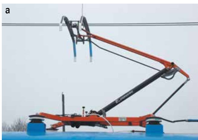
Fot. 2. Pantograf: a) typu EC-160 ze ślizgaczem pojedynczym i otwartym nabeżnikiem; b) typu WBL-85 DC ze ślizgaczem podwójnym (bliźniaczym) i otwartym nabeżnikiem
