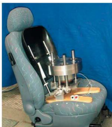
Rys. 6. Aktywny manekin antropodynamiczny (Memosik IV) umieszczony na fotelu [13]
