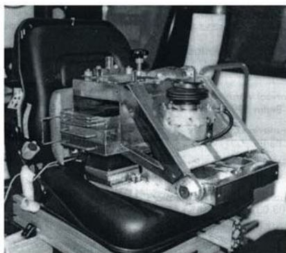
Rys. 2. Badanie fotela samochodowego z wykorzystaniem manekina [4]
