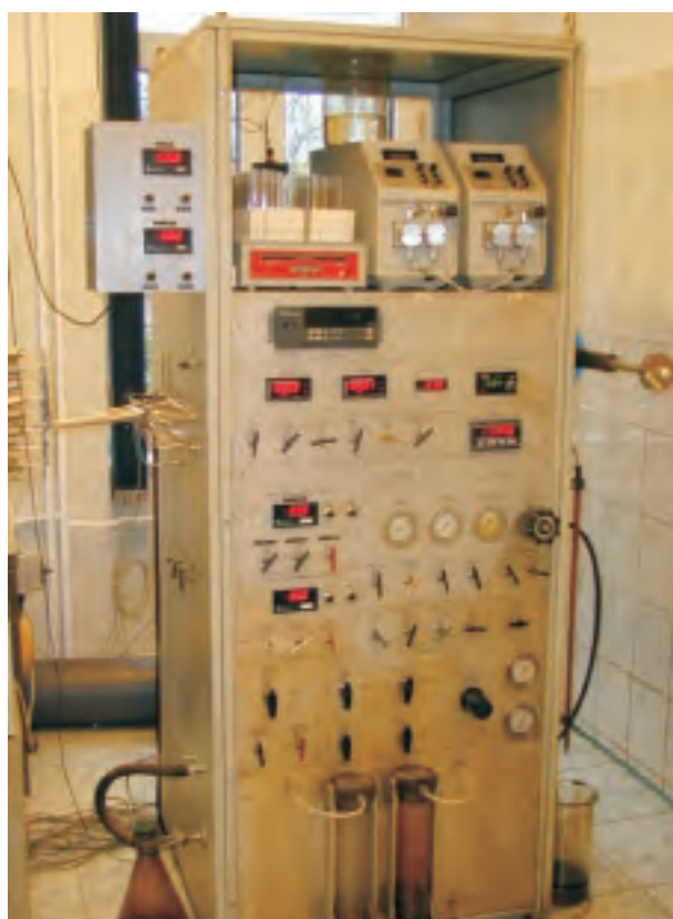
Fot. 2. Aparat firmy TEMCO używany w pracach doświadczalnych do pomiaru przepuszczalności rdzeni skalnych
