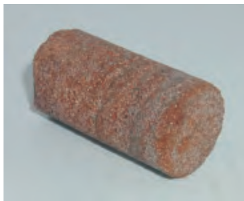
Fot. 1. Przykładowy rdzeń piaskowcowy użyty do badania zmian przepuszczalności
