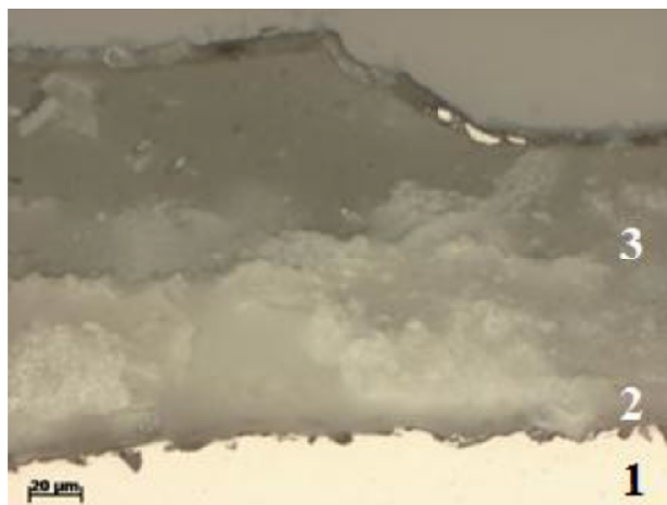
Rys. 5. Próbka B4 klejona cementem dentystycznym Relyx U100 3M ESPE, powiększenie 500x (1. Stop tytanu Ti-6Al-4V, 2. Cement dentystyczny, 3. Dwutlenek cyrkonu ZrO_2 )
