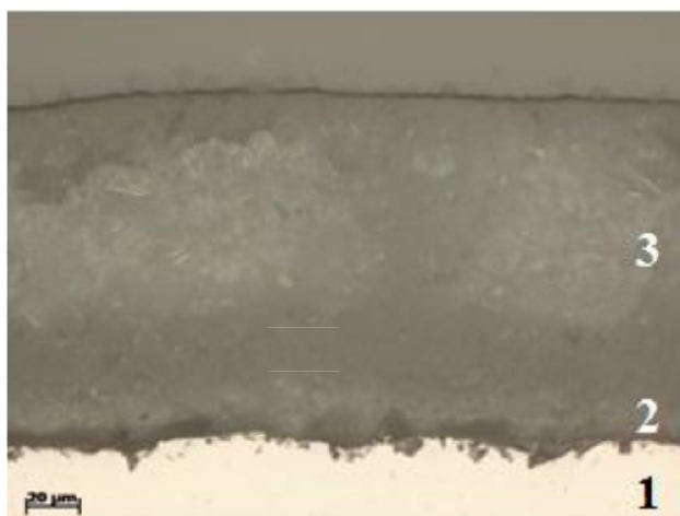
Rys. 4. Próbką A4 klejona cementem dentystycznym KoNcem Zirconium, powiększenie 500x (1. Stop tytanu Ti-6Al-4V, 2. Cement dentystyczny, 3. Dwutlenek cyrkonu ZrO 2 )
