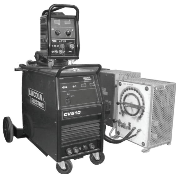
Rys. 5. Badane urządzenie spawalnicze obciążone opornicą
