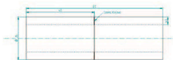
Rys. 1. Połączenie klejowe rur PP o średnicy 25 mm
