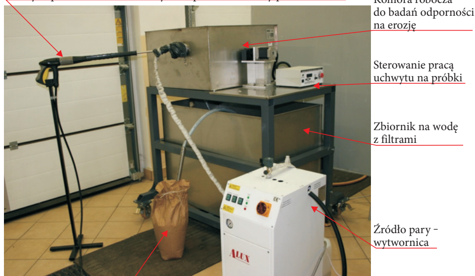
Rys. 7. Stanowisko do modelowych badań erozji powierzchni materiałów i powłok technologicznych w środowisku wody, pary wodnej, z możliwością oddziaływania ścierniwa na badaną powierzchnię
