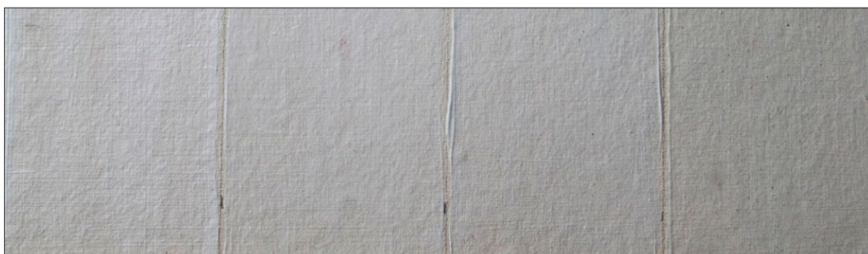
Ryc. 1. Efekt dodania do bieli ołowiowej sproszkowanego szkła w trzech różnych proporcjach.
