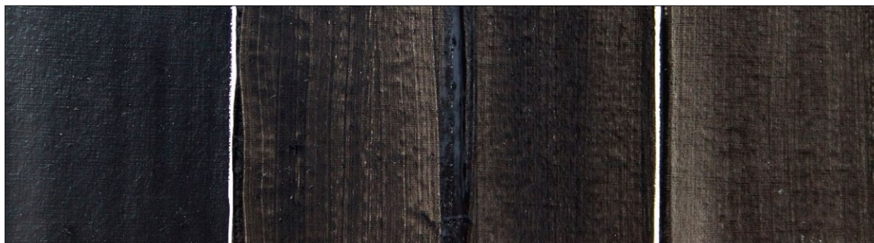
Ryc. 10. Efekt dodania do czerni kostnej sproszkowanego szkła w trzech różnych proporcjach. Fig. 10. The effects of adding powdered glass to bone black in three different proportions.
