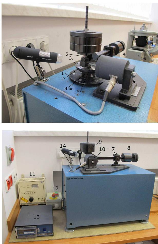
Rys. 1. Stanowisko badawcze do badań tribologicznych na bazie tribometru T-01M. Opis w tekście
